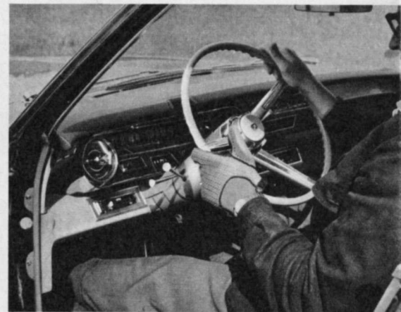
DAS LENKRAD läßt sich nicht nur wie beim Mercedes 600 axial verschoben (oben), sondern auch abkippen (unten). So kann man sich jede individuelle Stellung aussuchen.
