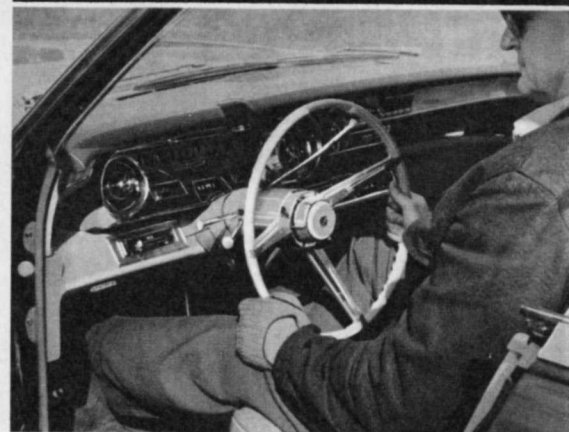
DAS LENKRAD läßt sich nicht nur wie beim Mercedes 600 axial verschoben (oben), sondern auch abkippen (unten). So kann man sich jede individuelle Stellung aussuchen.
